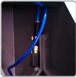
Brocha con agua para limpieza exterior.
