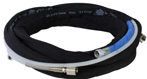
Conjunto de mangueras aire y producto para equipos de baja presión. Manguera de aire antiestática 8 x 15 mm. y manguera de producto 6 x 8 mm. con funda de Nylon. Manguera ligera y resistente. (Ver pág. 175)
