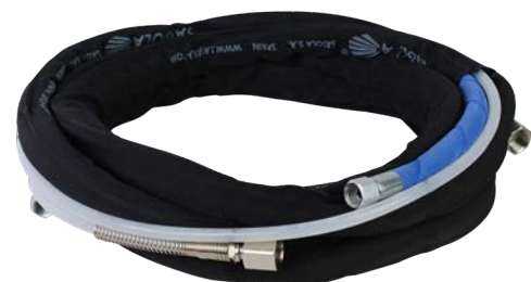
Conjunto de mangueras aire y producto para equipos de baja presión. Manguera de aire antiestática 8 x 15 mm. y manguera de producto 6 x 8 mm. con funda de Nylon. Manguera ligera y resistente. (Ver pág. 147)
